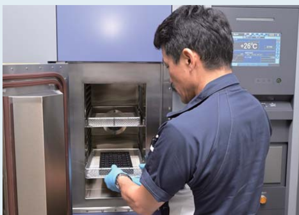
エスベックの冷熱衝撃装置(300℃タイプ)を用いて半導体パッケージの信頼性試験を実施する様子
