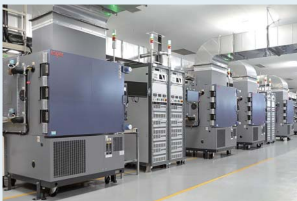
エスベックの充放電試験用恒温槽(本田技術研究所内) インターロック機能や消火装置を内蔵し試験の安全性を確保
