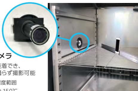
槽内の試料を撮影している様子
