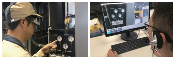
スマートグラスで遠隔地の装置状況を確認しながら作業支援を実施
