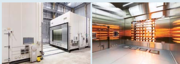
試験室は可動式のため建材の入れ替えが容易 (左) 日射・降雨装置を装備した試験室内 (右)
