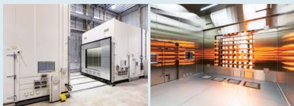
試験室は可動式のため建材の入れ替えが容易 (左) 日射・降雨装置を装備した試験室内 (右)
