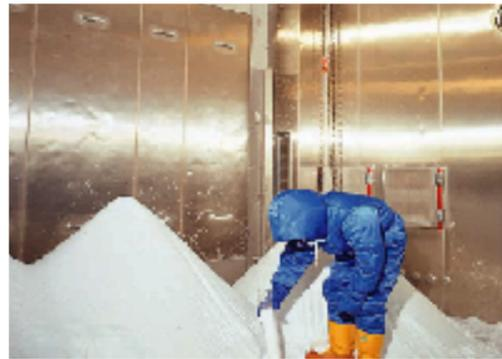
例えば、極寒の地を飛び立ち、数時間後には灼熱の空港に降り立つ飛行機は、短時間に100 近くの熱ストレスにさらされます。このストレスは、製品・部品の品質や信頼性に大きく影響を与えます。他にも、湿度、雨、雪、光、振動、圧力など。これらを装置内で再現し、品質保証や信頼性確保に役立てていただく装置が「環境試験装置」です。この技術は、半導体、液晶などの高度な生産技術、生産性にも大きく寄与しています。
