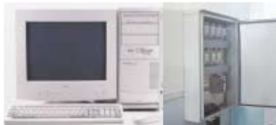
各工場(建物)単位の電力使用量の常時監視、事務所にて一括観測・監視
