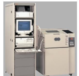
コンデンサ温度特性評価システム
