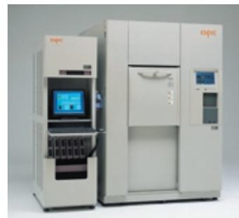
プリント基板・はんだ導体抵抗評価システム
