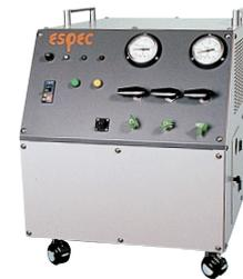
低沸点冷媒回収装置
