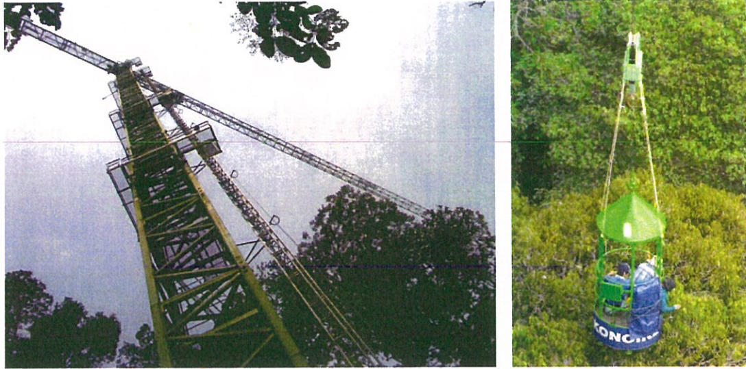
写真 1. 高さ 81m の林冠調査用クレーン (左) とそこから吊り下げられたゴンドラ (右).
