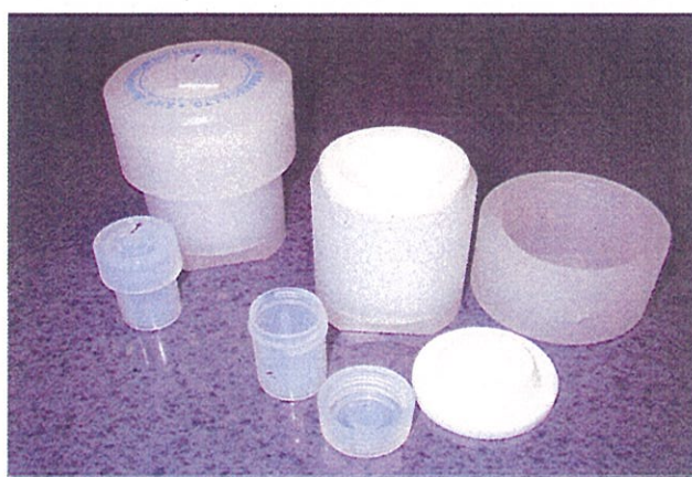
図 3b P-25 マイクロ波酸分解容器と DV-7 小容器。DV-7 に試料と酸を入れ、P-25 に密閉して電子レンジで加熱分解する
