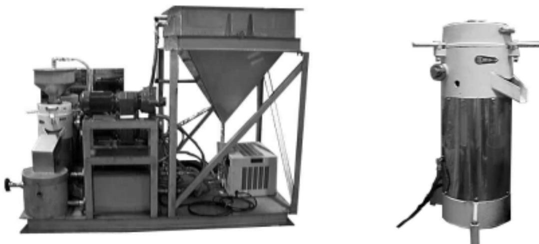
写真1 左：装置全体図、右：高速回転ディスク
