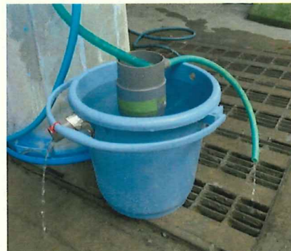
図 3 透水試験装置図
