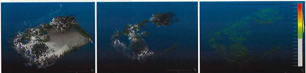
図3 CloudCompareを用いた樹冠ボリューム解析、公園における3次元点群データ(左)、公園点群データから抽出された樹冠(中)、樹冠点群データの対照高度を表した画像(右)
