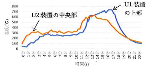
図 4 簡易乾留ガス化装置内の温度変化
