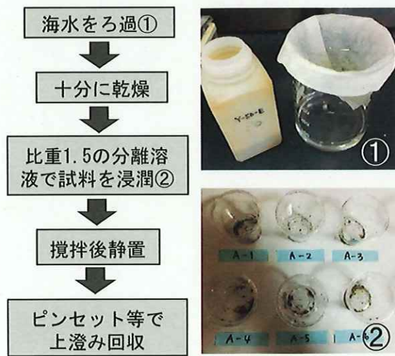
図-5 マイクロプラスチックの分離手順
