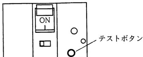
図6.1 漏電遮断器の動作テスト
