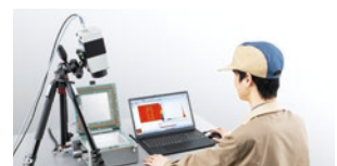
サーモグラフィ+卓上型無風恒温槽
