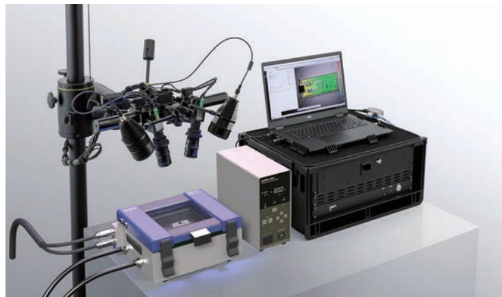
熱変形計測システム 3D DIC+卓上型無風恒温槽
