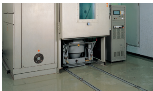
振動発生機レール移動方式
