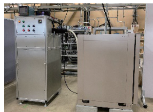
圧力間欠 試験装置
