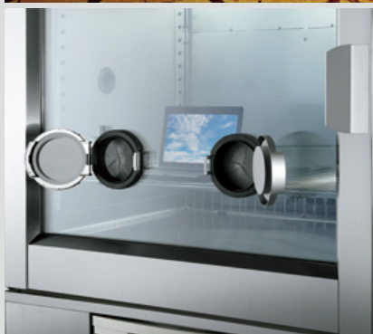
電子機器・部品を試験する恒温恒湿器
