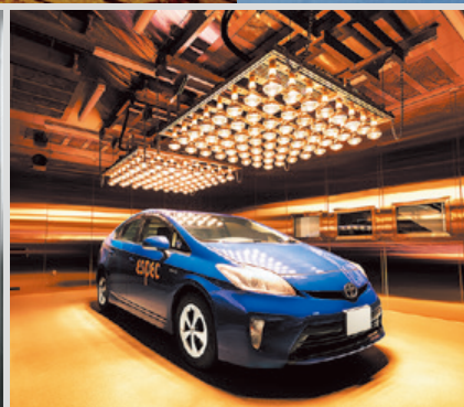
自動車1台が入る車輛環境試験室
