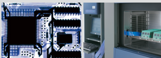
環境試験器と接続して、高精度な試験が可能 導体抵抗評価システム
