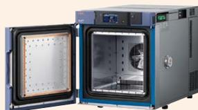
温度範囲: -40℃～+100℃の卓上タイプでシールド機能を有した恒温器。省スペースで端末、エッジデバイスの高/低温動作試験や温度特性試験時のEMC対策に最適です。
