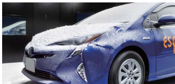
全天候型試験ラボ内（降雪試験）
