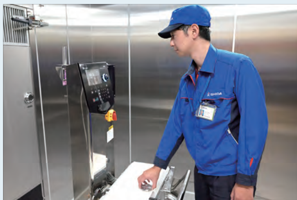
生産ライン上で高精度な質量チェックが行える「ウェイトチェッカー」をエスペックの恒温恒湿室内で性能評価
