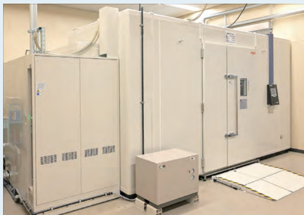
エスペックの恒温恒湿室「ウォークインチャンバー」 恒温恒湿室の床構造を改作することによって コンベアの振動によるはかりへの影響を低減
