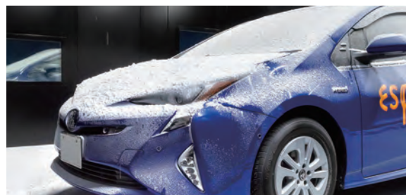
全天候型試験ラボ内（降雪試験）
