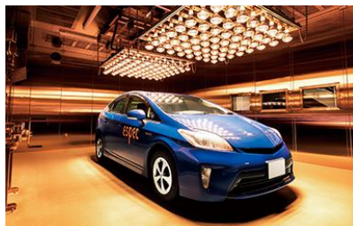
自動車が一台入る 実車試験装置
