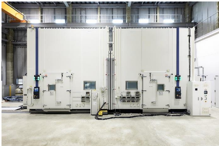
恒温(恒湿)室 建材用試験室
