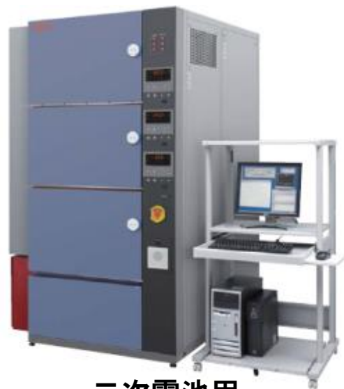
二次電池用 充放電評価装置
