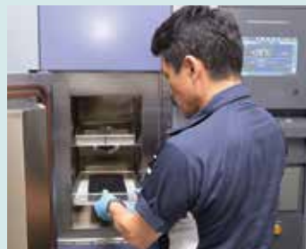
当社の冷熱衝撃装置を用いて半導体 パッケージの信頼性試験を実施する様子
