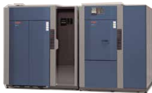
高発熱負荷対応「バーンインチャンバー」 -20^{\circ}\text{C} ～ +150^{\circ}\text{C} の温度範囲内において許容発熱量を従来比4倍に拡大
