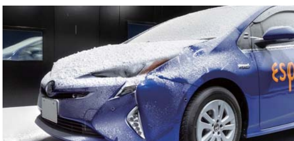
全天候型試験ラボ（降雪試験）
