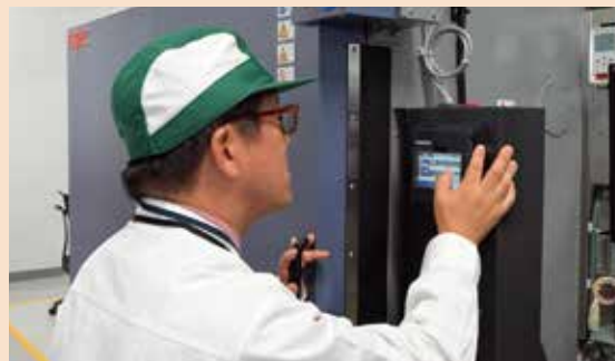
電池の性能を評価する充放電試験の様子
