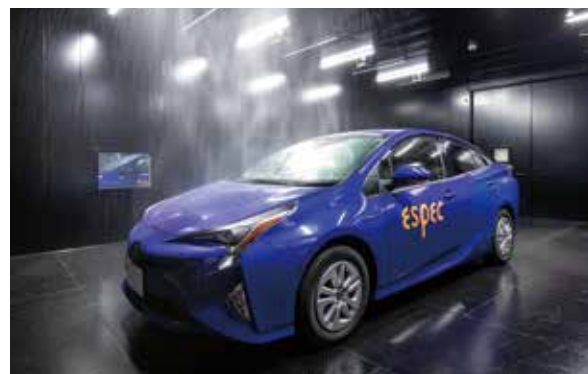
降雨や霧、降雪環境を再現できる当社「全天候型試験ラボ」 自動運転用センサーの性能評価方法を研究
