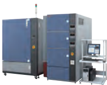
二次電池向け充放電評価装置 充電・放電を繰り返し性能や耐久性を評価
