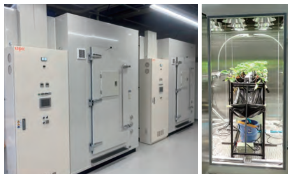
作物の栽培環境を精密に制御する人工気象室 国立研究開発法人 農業・食品産業技術総合研究機構様に納入
