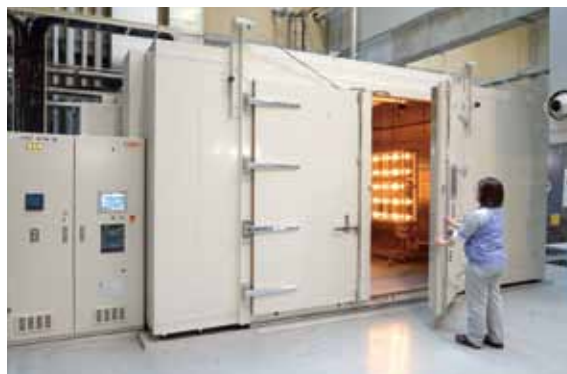
SAITECに納入した人工気象室 灼熱の砂漠、亜熱帯、寒冷地などあらゆる環境が再現でき、実際に使用される気象環境下で製品の信頼性評価を行えます
