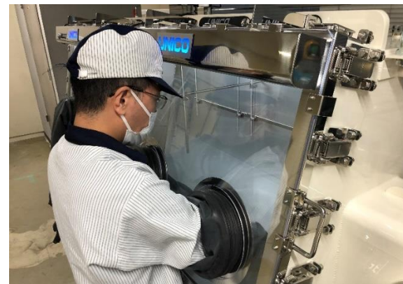
セル解体用グローブボックス
