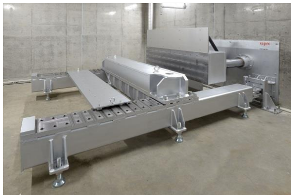
圧壊試験機(第1安全試験室)
