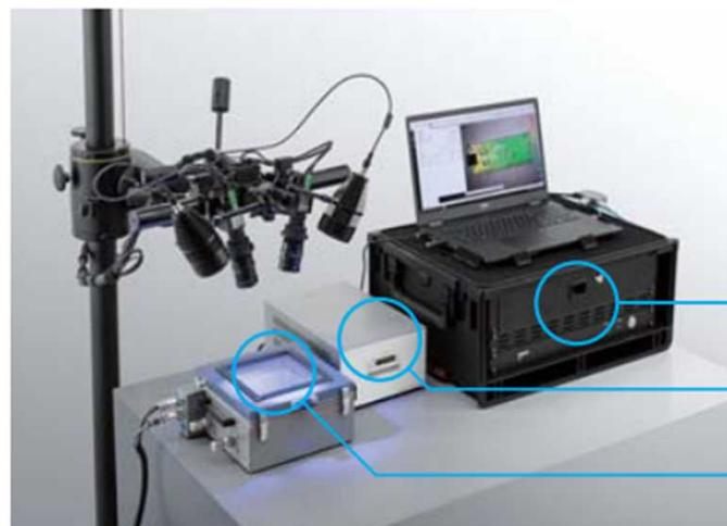
熱変形計測システム
