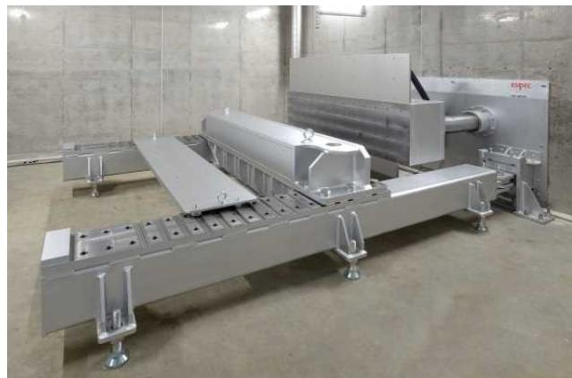
圧壊試験機(第1安全試験室)
