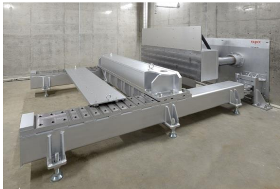
圧壊試験機(第1安全試験室)
