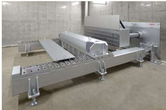
圧壊試験機(第1安全試験室)
