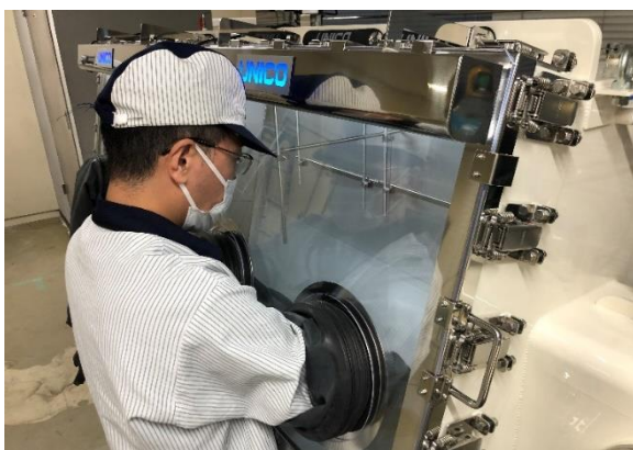
セル解体用グローブボックス
