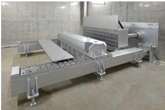
圧壊試験機(第1安全試験室)
