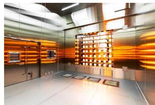
照射装置と散水(降雨)装置を
