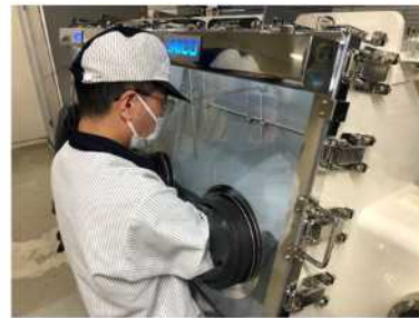
セル解体用グローブボックス
