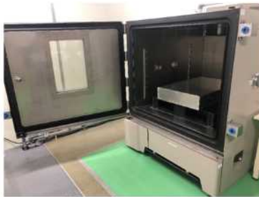
パック電池低温解体槽
