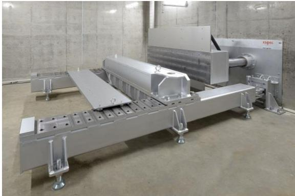
圧壊試験機(第1安全試験室)
