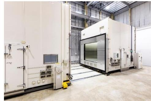
恒温(恒湿)室は可動式になつており、試験用建材の入れ替えが容易にできます
