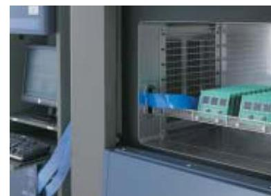
電子部品のはんだ接合部分の信頼性を電気的に評価
