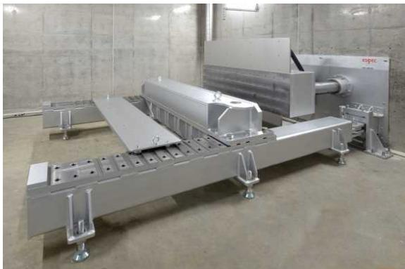
圧壊試験機(第1安全試験室)
