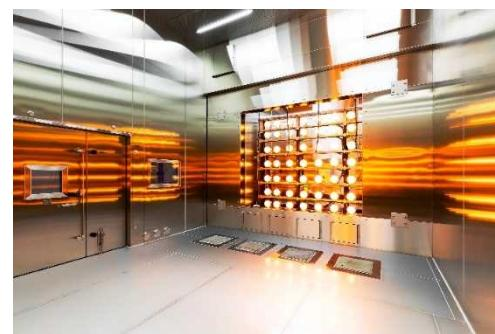
照射装置と散水(降雨)装置を
