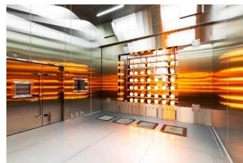
照射装置と散水(降雨)装置を
