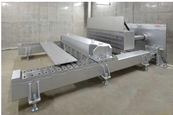
圧壊試験機(第1安全試験室)
