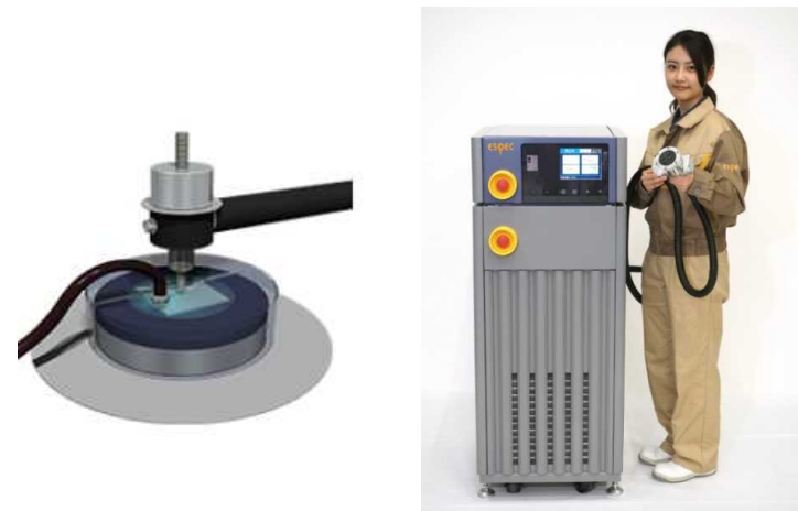
摩擦摩耗試験機・硬度計とのセットアップ例(左) スポット冷却加熱装置(右)
