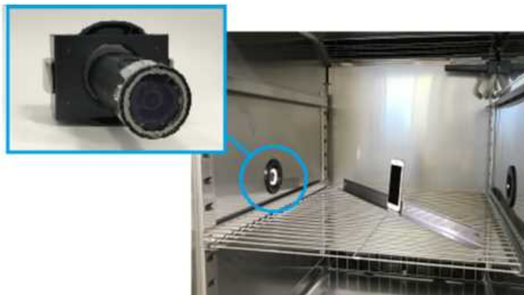
槽内監視カメライメージ
