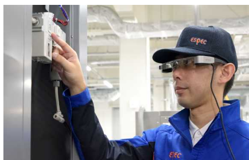
スマートグラスを用いた遠隔作業支援
