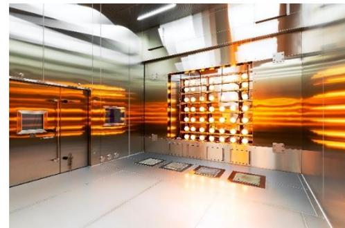
照射装置と散水(降雨)装置を装備し、屋外の気象環境を再現します
