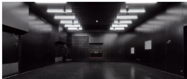
試験室 幅6m×奥行9m×高さ3m
