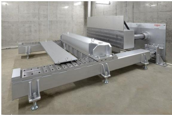
圧壊試験機(第1安全試験室)
