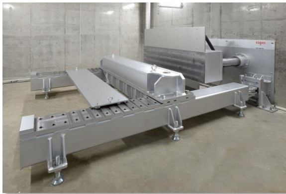
圧壊試験機(第1安全試験室)
