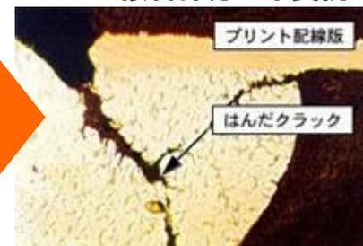
電子部品のはんだ接合部分の信頼性を電氣的に評価
