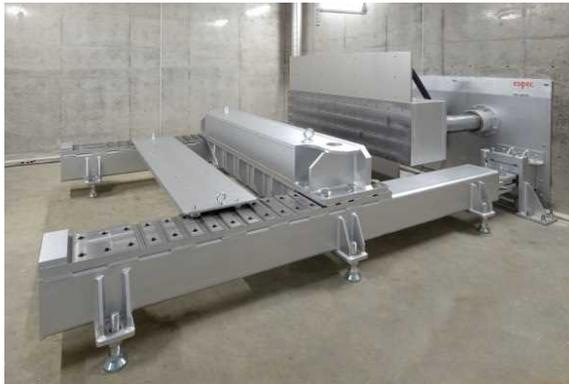
圧壊試験機(第1安全試験室)
