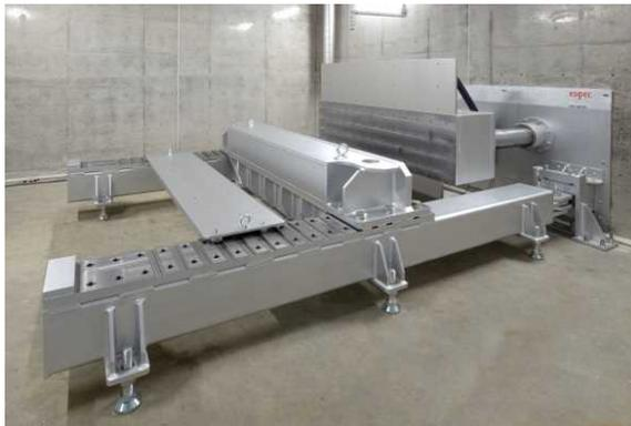
圧壊試験機(第1安全試験室)
