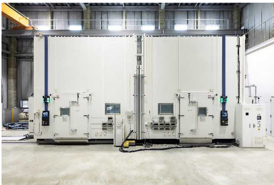
恒温(恒湿)室 建材用試験室
