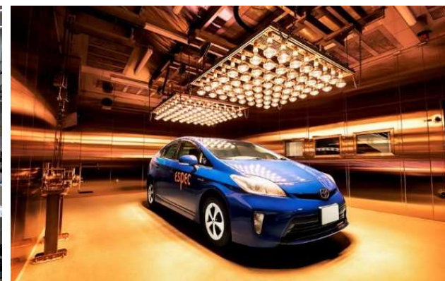
恒温(恒湿)室 実車試験装置
