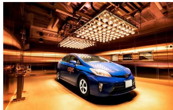
恒温(恒湿)室 実車試験装置
