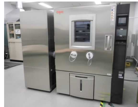
低湿恒温恒湿槽
